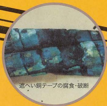
遮へい銅テープの腐食・破断
