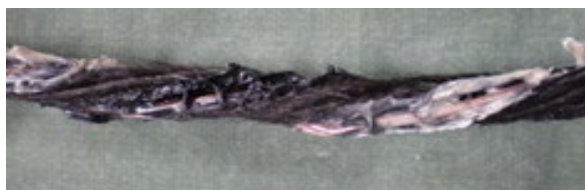
過電流により絶縁体が軟化・熔融した例
