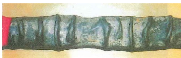
薬品によりシースが膨潤した例
